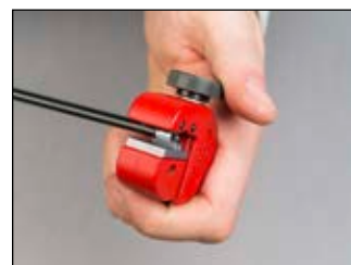
Pozycjonowanie przewodu w celu zeszkrobania płaszczu z tworzywa sztucznego
